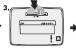
3. Вставьте пластиковую карту либо CD/DVD диск в проем загрузки . Аппарат начнет работать автоматически
