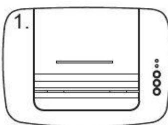
Нанесите смазочную жидкость на проем загрузки
