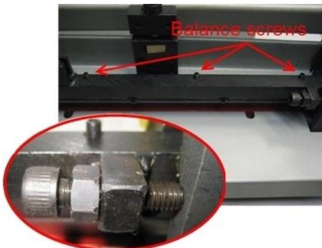
Они доступны при снятой верхней крышке.
