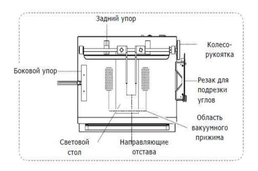
Перед изготовлением крышки отрегулируйте положение направляющих в соответствии с размером книги и расположением меток. Боковой и задний упоры используются для серийного производства крышек и при применении непрозрачного материала для обложки. На световом столе имеется измерительная шкала, которая помогает выровнять положение обложки. Отстав удобнее располагать относительно центральной линии. Область вакуумного прижима позволяет удерживать обложку при наложении сторонок.
